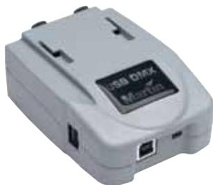
Martin USB Duo DMX интерфейс имеет разъемы 5-pin XLR «мама» для подключения устройств, он соединяется через USB с любым компьютером на базе ОС Windows и позволяет получить 2 DMX-юниверса по 512 каналов. Интерфейс сообщается с Martin LightJockey, с контроллерами серии M и M1, с медиа серверами Maxedia и Martin ShowDesigner 5 (MSD5), а также с загрузчиками ПО для устройств Martin (не совместим с программой MUM).
