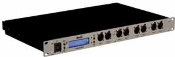
Ether2DMX8 — это мощный DMX маршрутизатор от Martin, дополненный рядом других полезных характеристик. Выполняя функцию роутера, он передает данные протокола Artnet из и в DMX юниверсы. Помимо этого устройство объединяет DMX сигналы, служит распределителем сигнала, исполняет роль предохранительно-блокирующего устройства, воспроизводит cue и осуществляет необходимый мониторинг DMX сигнала.
