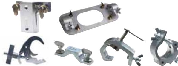
Монтажные скобы Martin изготавливаются из высококачественного прессованного алюминия и поставляются в комплекте с болтом M12 8.8 со степенью надежности А и самостопорящейся гайкой для максимальной надежности и крепятся на уже существующие или новые модели зажимов типа «омега» на 1/4 оборота. Все скобы и зажимы выпускаются с маркировкой TÜV и SWL.
