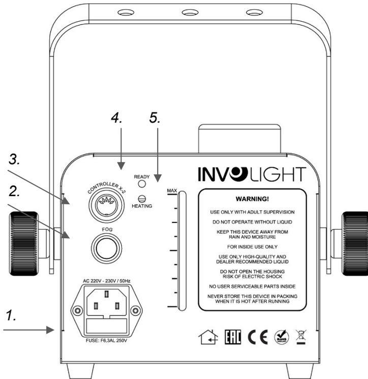
1. POWER IN: входной разъем питания IEC переменного тока с предохранителем F12AL250V.
