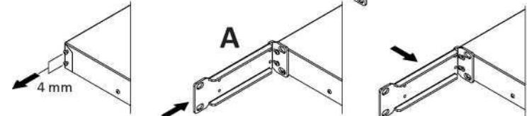
**Монтаж на поверхности** - Используя 2 «кронштейна В», можно установить усилитель вертикально на стене или вверх ногами под столом или на потолке. В последнем случае просто переверните скобки вверх ногами.
