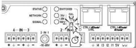
Нажмите кнопку до тех пор, пока светодиод «Network» не станет фиолетовым, а затем отпустите его в течении 2 секунд. Это сбросит усилитель на назначение авто-IP адреса, он переключит режим Ethernet и обновит индикатор «Switched»:
