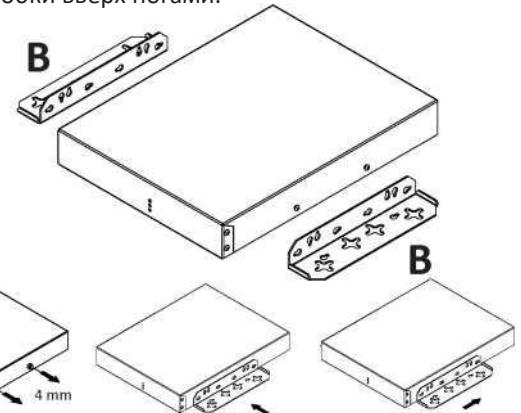
**Монтаж на поверхности (скрытые скобки)** - Используя 2 «кронштейна В», можно установить усилитель, как показано в предыдущем случае, при этом скрывая скобки под Mezzo. Используйте шаблон для сверления (входит в комплект поставки), чтобы закрепить не менее 2 винтов на стене, прикрепите кронштейны к усилителю, а затем просто наденьте его на настенные винты.
